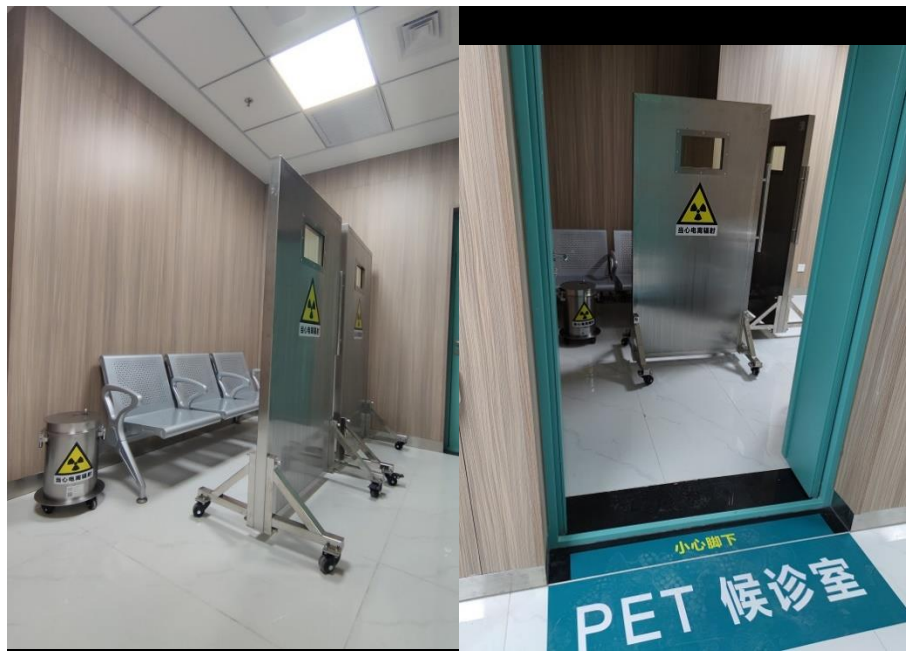
PET/CT 候诊室，放置 2 个铅垃圾桶（20 mmPb），3 个铅屏风（10 mmPb）
