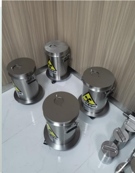
废物间配备有 4 个放射性废物桶（2 个 10 mmPb，2 个 20mmPb）
